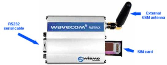
Gambar 2.5 Modem Wavecom Model M130B
