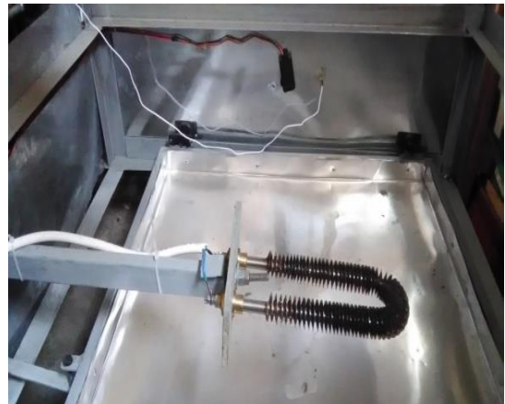
Gambar 4.11 Rancangan pengukuran panas suhu sensor dan Thermometer
