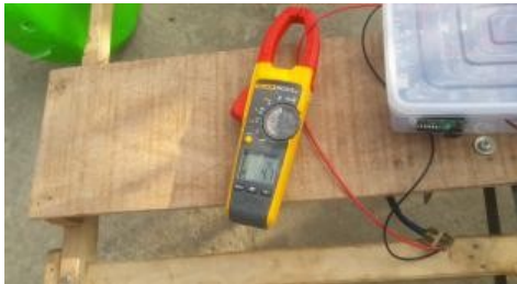
Gambar 4.9 contoh pengukuran Arus menggunakan tang amper.
