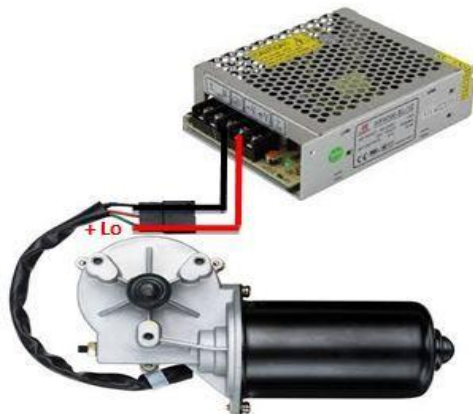
Gambar 8. Rangkaian pengujian motor wiper (+) Lo
