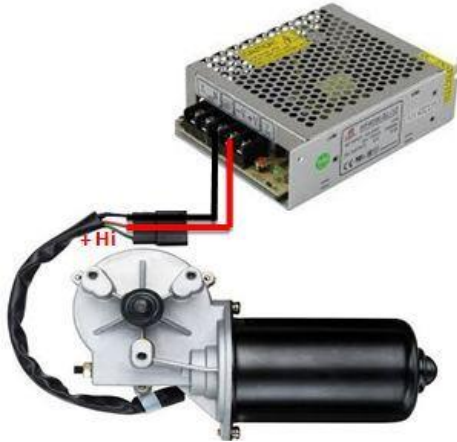
Gambar 7. Rangkaian pengujian motor wiper (+) Hi
